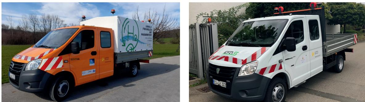
**Abbildung 12** Nutzfahrzeug mit Wasserstoff-Antrieb (l.), Elektro-Transporter (r.)
